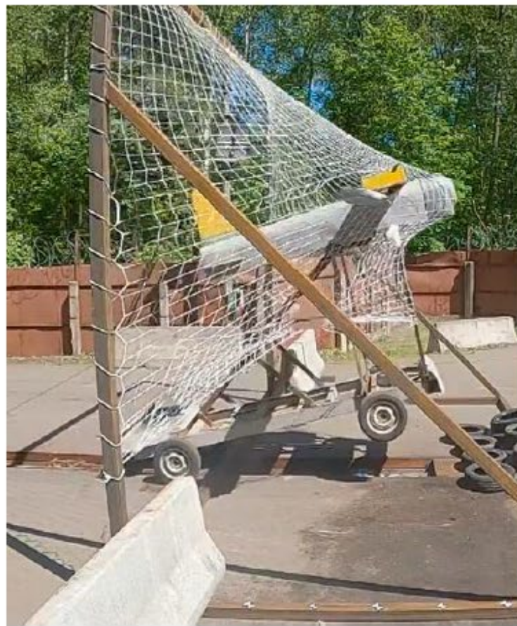
Растяжение. Погашение энергии БПЛА
